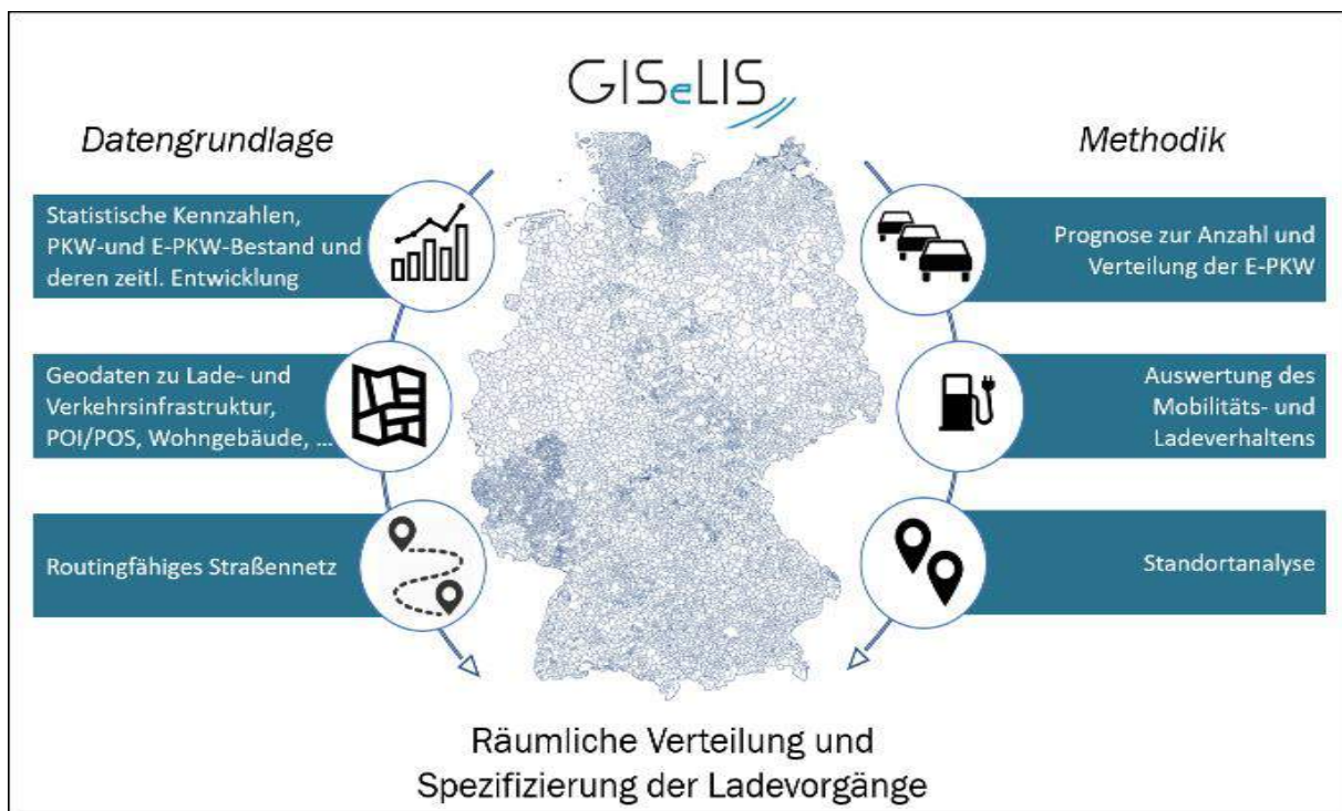
Abbildung 24: Funktionsweise des Standortmodelles für Ladeinfrastruktur GISeLIS
